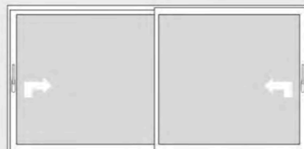
Επάλληλο Δίφυλλο με στενό γάντζο 2-Leaf lift&slide with narrow hook (90° cutting)
