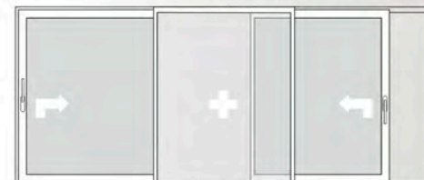
Επάλληλο Δίφυλλο με Σταθερό 3-Lift&slide with 1 central fixed
